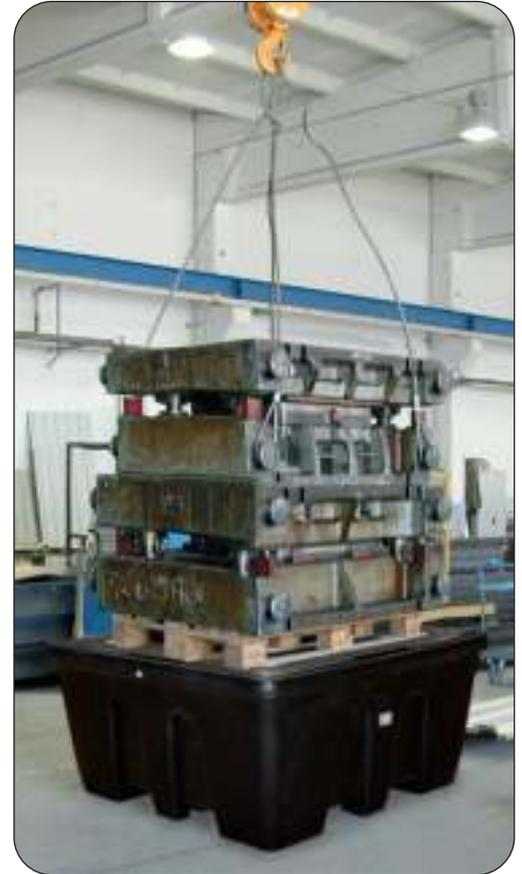
**Auffangwanne PE-KT-15 unter einer Prüflast von 8.000 kg**
