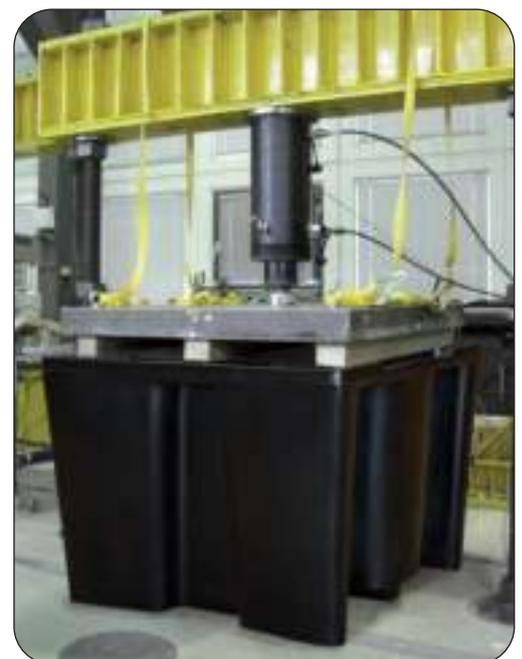
**Auffangwanne PE-KT-1 unter einer Prüflast von 8.000 kg**
