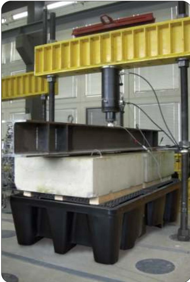
**Auffangwanne PE-KT-2 unter einer Prüflast von 16.000 kg**
